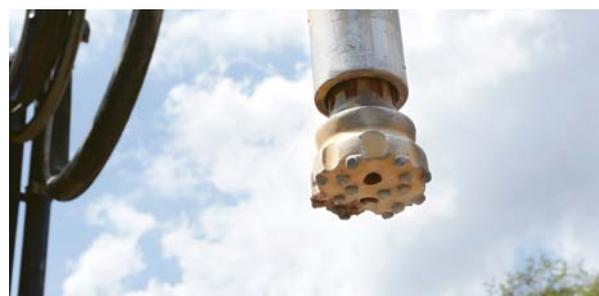
Über eine Erdwärmehochung ziehen Sole-Wärmepumpen Energie aus dem Boden. In der in das Bohrloch eingebrachten Sonde zirkuliert ein Wasser-Frostschutz-Gemisch (die Sole) und entzieht so in 100 Metern Tiefe oder mehr dem Erdreich die Wärme.
