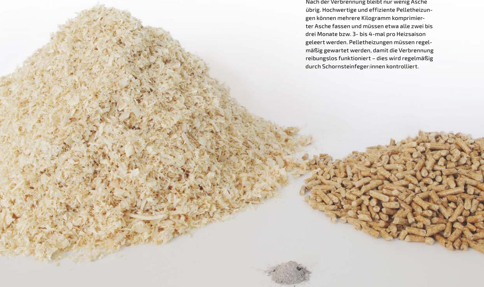
Nach der Verbrennung bleibt nur wenig Asche übrig. Hochwertige und effiziente Pelletheizungen können mehrere Kilogramm komprimierter Asche fassen und müssen etwa alle zwei bis drei Monate bzw. 3- bis 4-mal pro Heizsaison geleert werden. Pelletheizungen müssen regelmäßig gewartet werden, damit die Verbrennung reibungslos funktioniert – dies wird regelmäßig durch Schornsteinfeger:innen kontrolliert.
