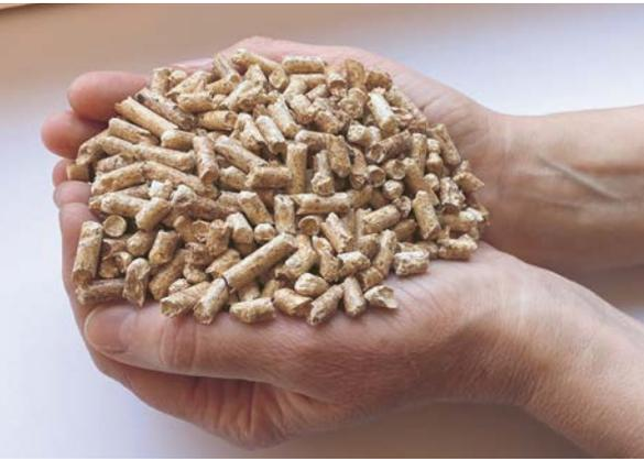
Ungefähr 200 Gramm Pellets werden benötigt, um eine Kilowattstunde (kWh) Wärme herzustellen. Je nach Größe und Dämmstandard benötigt ein Einfamilienhaus wenige tausend bis mehrere zehntausend kWh pro Jahr.
