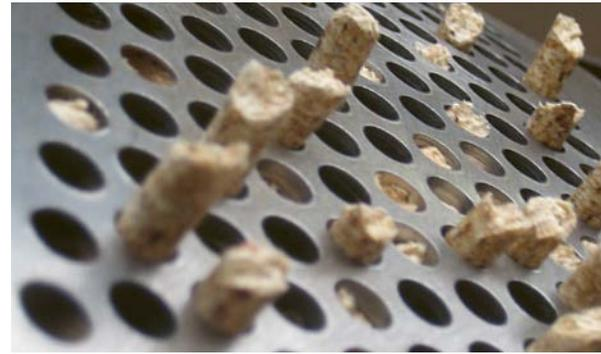
Holzspäne werden durch eine Matrize gepresst – so entstehen Pellets.
