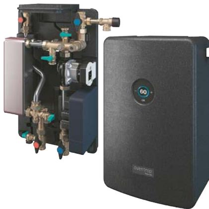
Die Frischwasserstation ist ein kompaktes Bauteil zur hygienischen Warmwasserbereitung. Sie setzt sich im Wesentlichen aus einem Wärmeübertrager sowie einer Pumpe zusammen und erwärmt Trinkwasser nur bei Bedarf.
